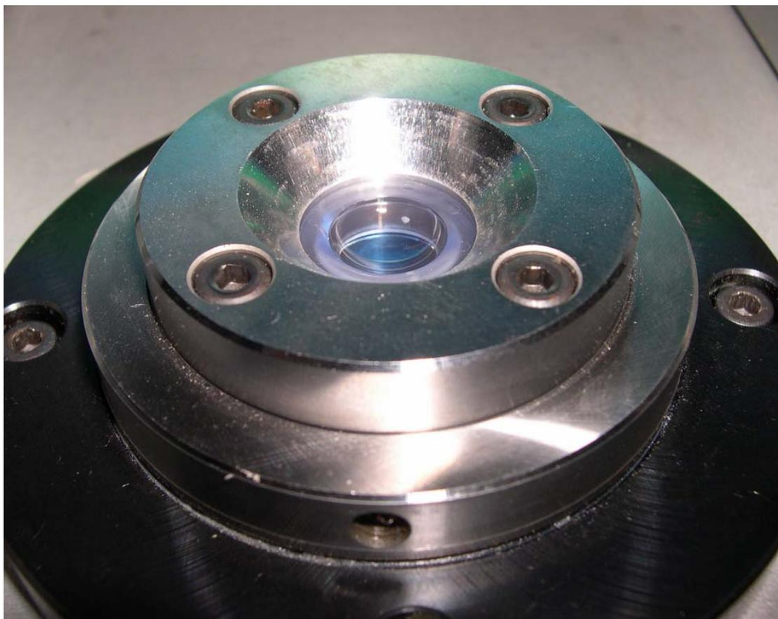
圖 1.3：旋模成型法的機具
