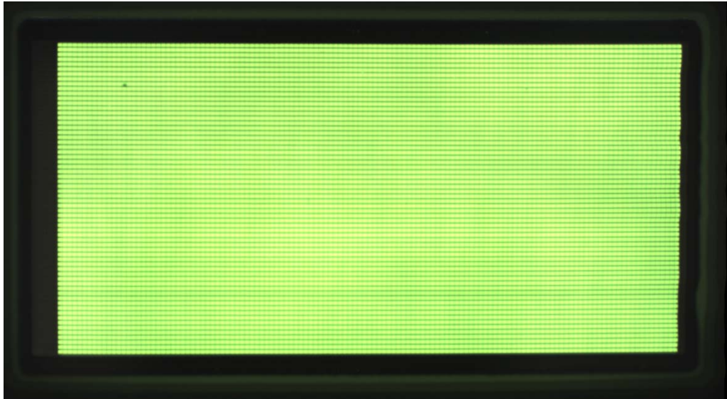
圖 4.3 參數實驗之較均勻 PLED 樣本通電影像
