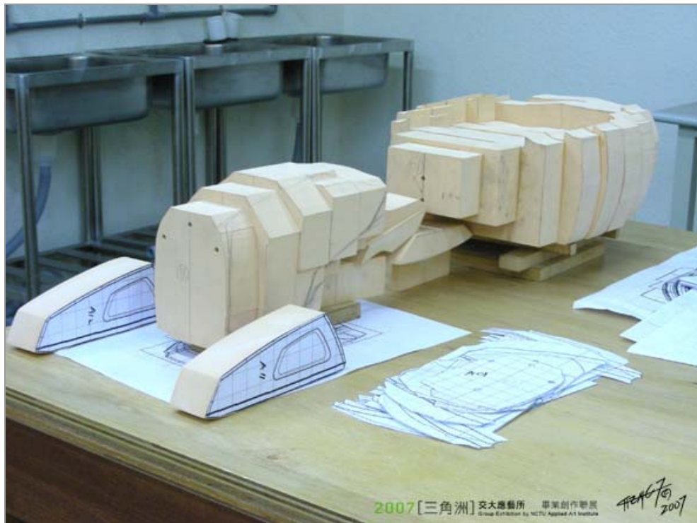
圖 4-60 《神獸》模型製作過程—主體斷面切割組合 04
