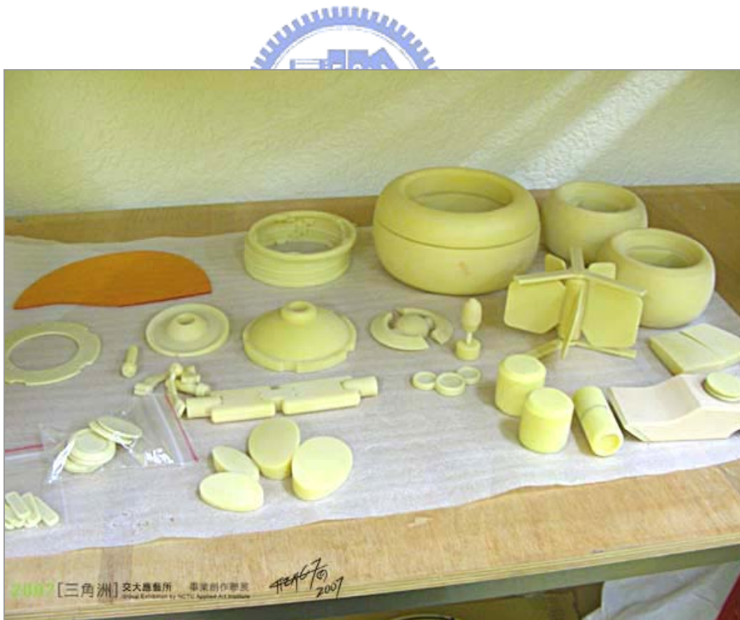
圖 4-21 《風火輪》模型製作過程—主體外形精修磨製
