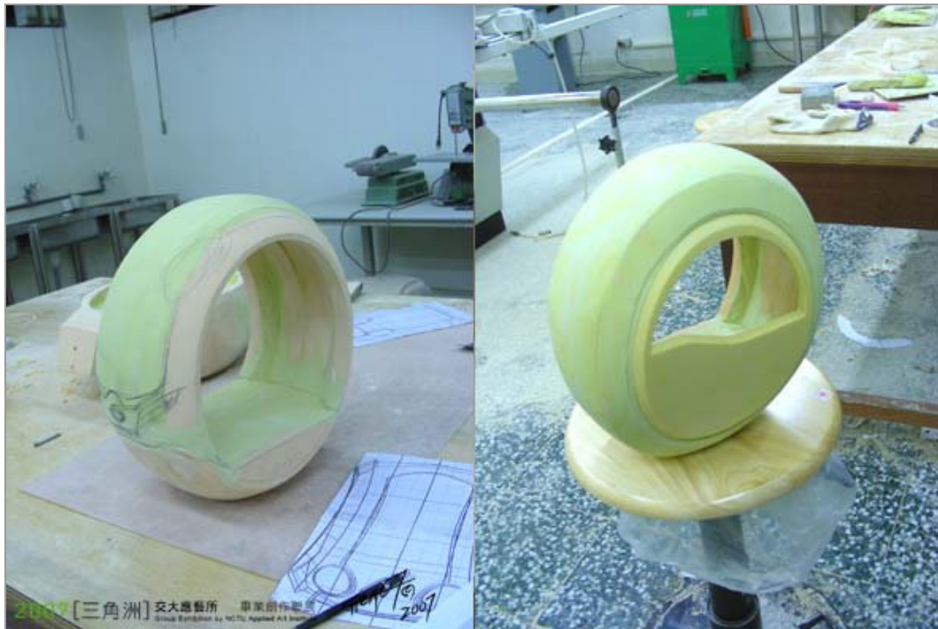
圖 4-20 《風火輪》模型製作過程—主體外形精修磨製
