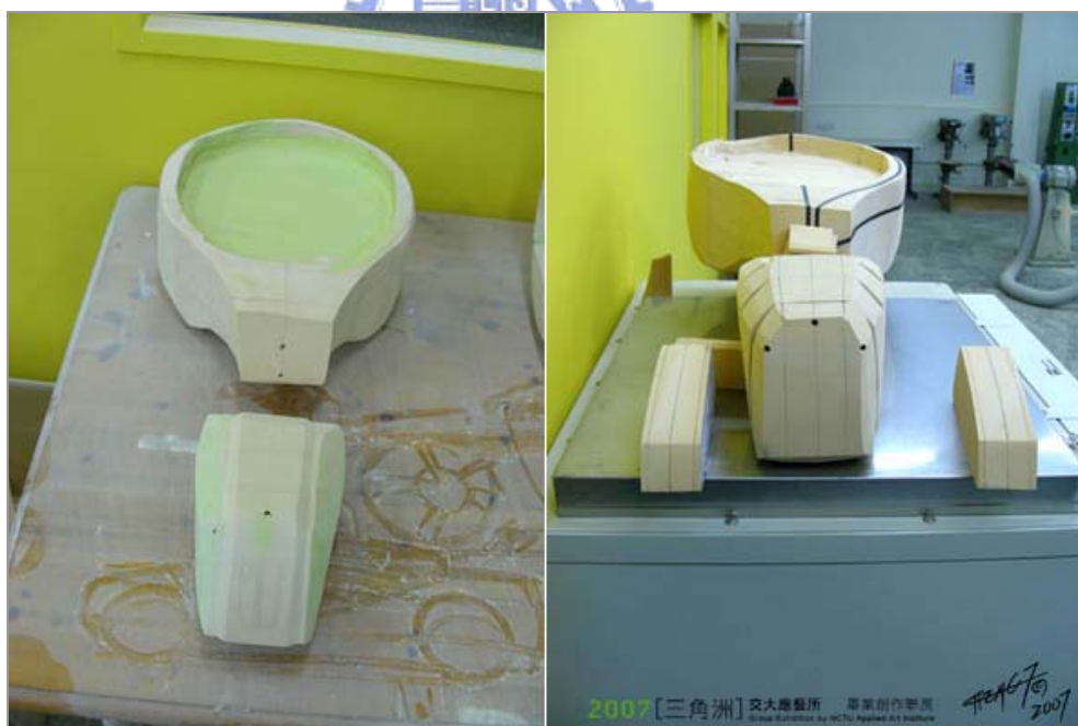
圖 4-61 《神獸》模型製作過程—外形初步磨製
