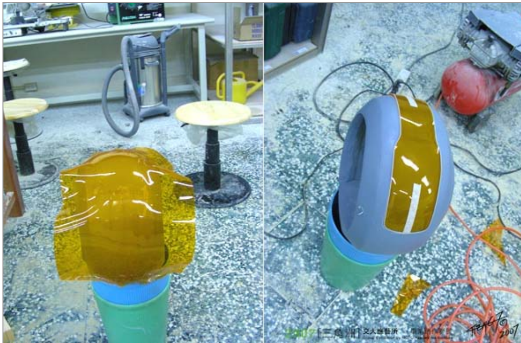
圖 4-22 《風火輪》模型製作過程—底漆與透明的翻製
