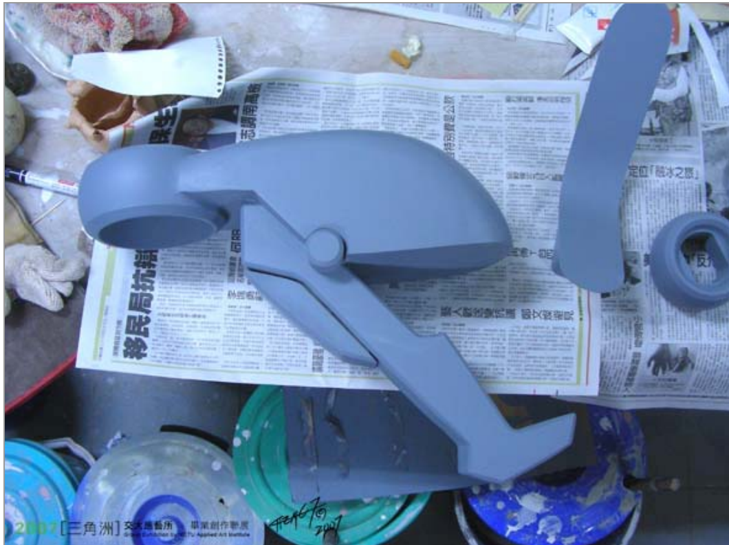
圖 4-45 《合體》模型製作過程——主體底漆噴塗
