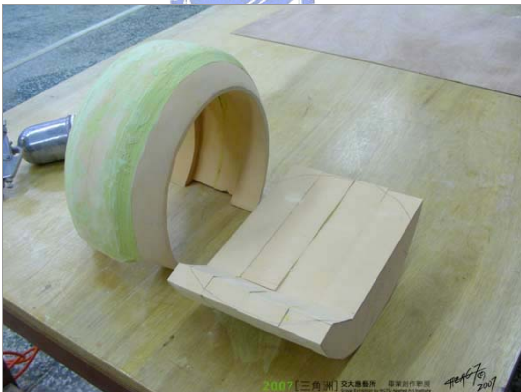
圖 4-19 《風火輪》模型製作過程—主體外形磨製
