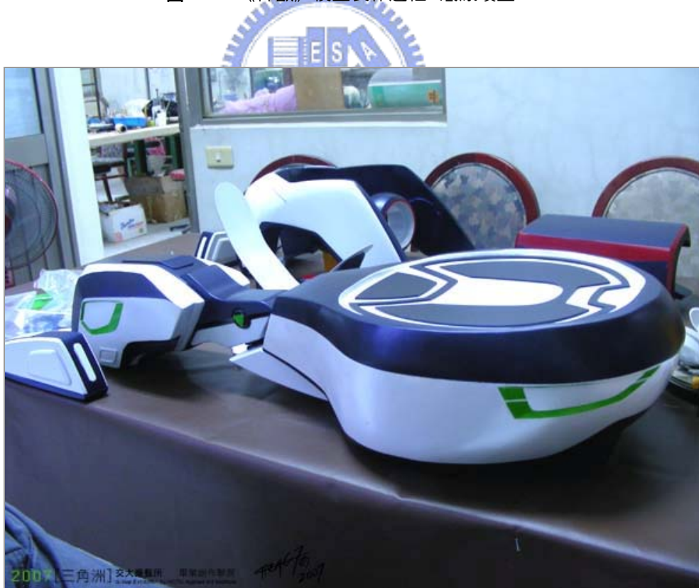
圖 4-65 《神獸》模型製作過程—色漆噴塗 01
