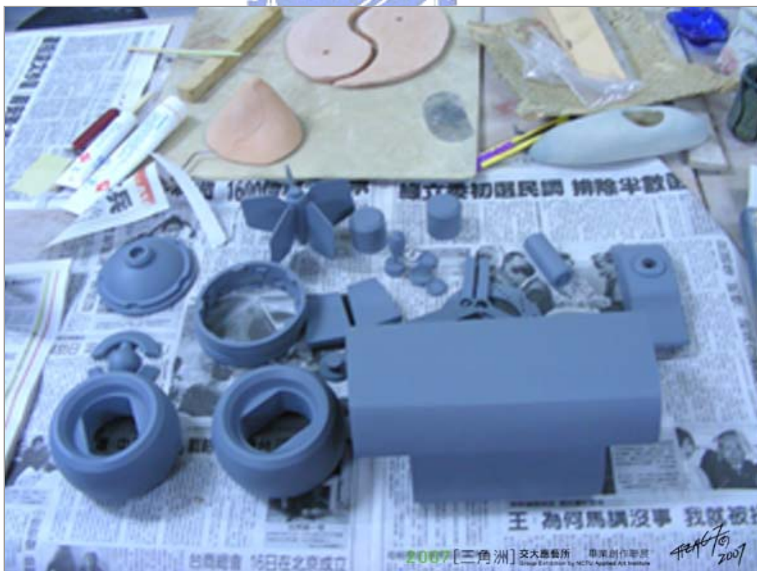
圖 4-46 《合體》模型製作過程——零組件底漆噴塗
