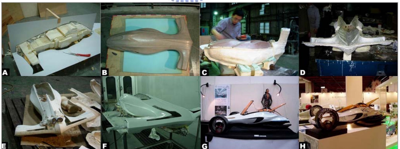
圖 3-6 汽車設計實體模型製作流程
