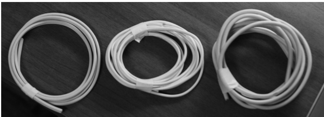
圖 2.95 電線 由左至右：3mm, 2.8mm, 5mm(尺寸皆為單一電纜的外徑)
