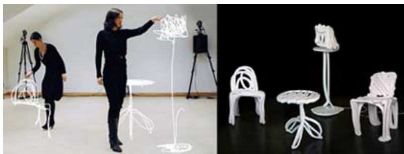
圖 15 FRONT 讓設計者直接在空間設計家具，並利用 CNC 輸出為實物(2006)
