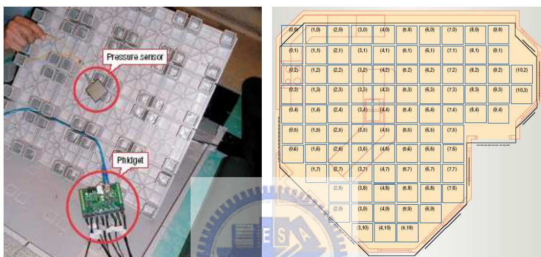
圖 2-8、感測地墊(左)，Smart Floor 配對系統(右) (Helal et. al, 2005)
