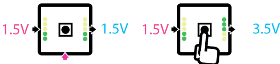
Fig. 4.8: 反相邏輯組件的中央按鈕，會將輸入值做反轉處理做變化輸出
