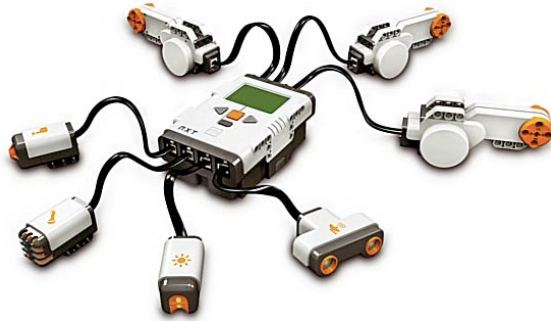
a. NXT透過自定的接線規格來與各零件相連
