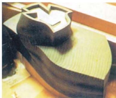
圖 3-47 CNC milling 模型
