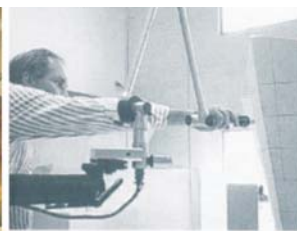
圖 3-44 運用 FARO 數位儀過程
