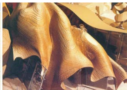
圖 3-11 雷射切割紙張堆疊整體模型
