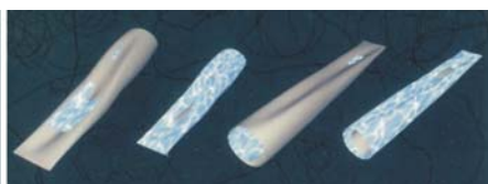
圖 4-37 擠壓圓管的單側，使管身自然產生形變
