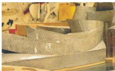
圖 3-43 將實體模型上繪製格點
