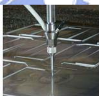
圖 2-8 CNC waterjet Machining
