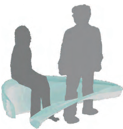
取出不同片段去loft出基本型再定義他的scale。
