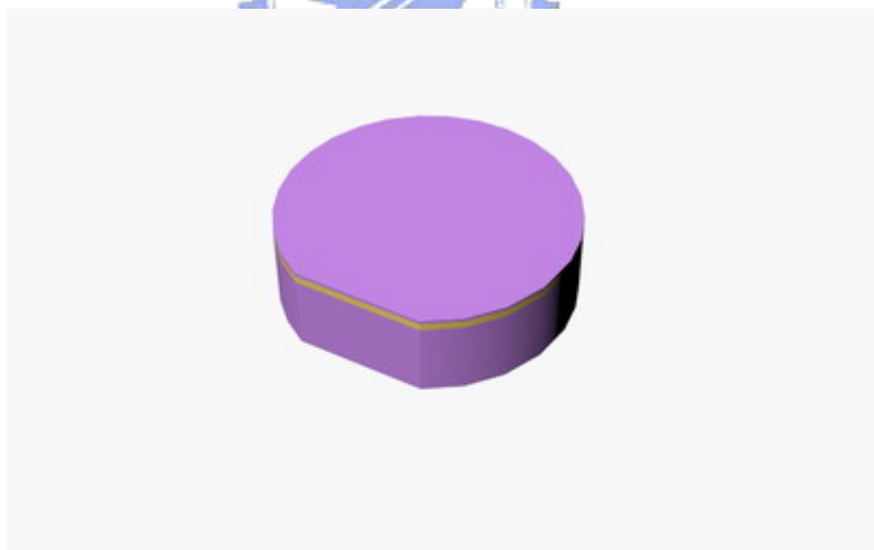
圖 2-4、 6”SOI wafer，最上層的 Si 厚度是 150 Å，BOX oxide 是 1500 Å
