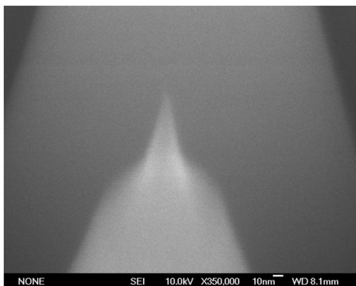
圖 3-4-2-1a 為探針大小 200nm，距離為 200nm 的 SEM cross-section 尖端影像圖
