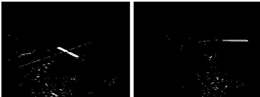
圖 2.6 將圖 2.2 先轉至 HSI 色彩模型，再作二值化後的結果。
