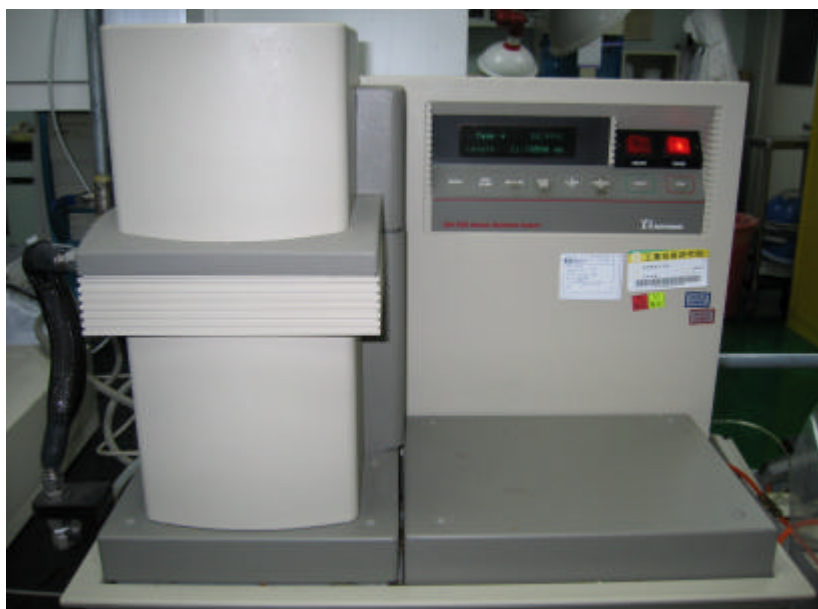
圖 3-5 用來高溫拉伸 PI 薄膜的 TA DMA 2980
