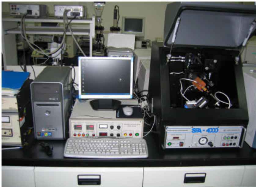
圖 3-7 SPA-4000 折射率量測儀
