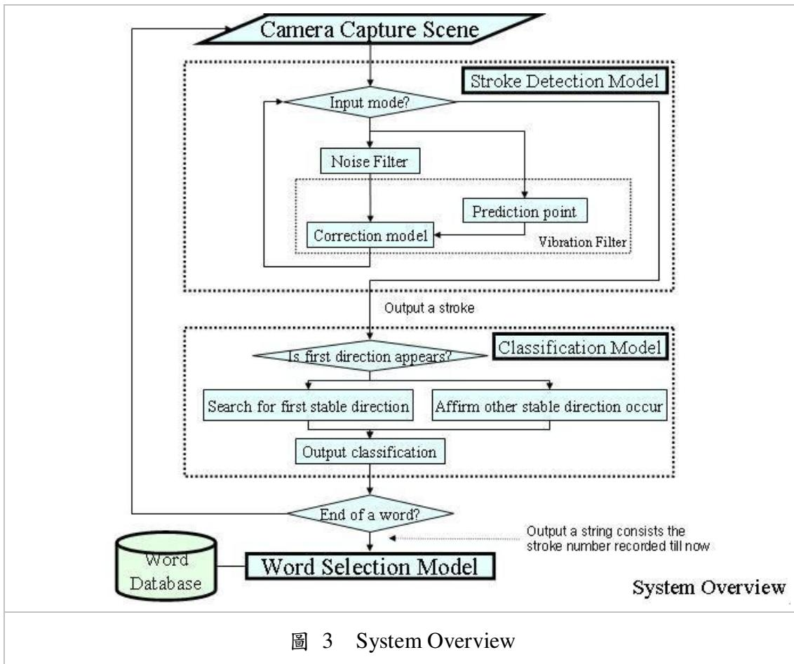
第一部分的系統大致上可以分為 Camera Capture Scene , Stroke Detection Model , Classification Model , 第二部分主要的內容是 Word Selection Model , 和一個已經建構好的 Word Database 。
