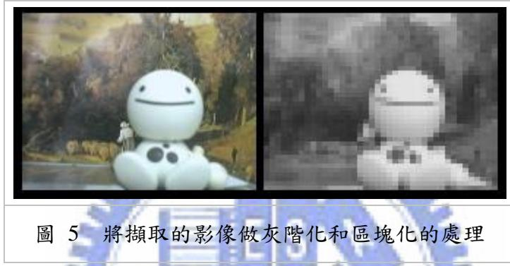
基於降低運算量的考量，在將擷取到的 frame 灰階化之後，更進一步的把畫面切割成一塊塊的 block，而每一個 block 的灰階值所代表的是整個 block 涵蓋的 pixel 之平均灰階值。而 block 的大小，也可以依照系統需求進行調整，比如說一般拿著攝影機在空中移動，我們會發現左右移動的範圍通常比上下來的大。因此在此考量下我們所採用的 block 並不是正方形，而是使用矩形來實做，藉由縮小 block 上下所涵蓋的 pixel 數目，來增加偵測攝影機上下移動時的精密度。
