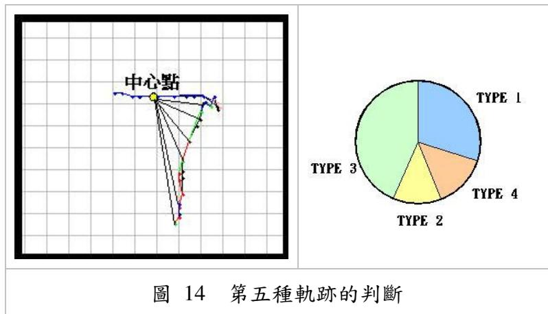
由上圖所示，第一個被偵測到的特徵方向向量為 TYPE 1，之後算出中心點後，藉由該特徵線段的中心點去檢查剩下的點，可以發現範圍跨越了 TYPE 4 和 TYPE 2，因此這個輸入軌跡便會被系統辨別為第五類軌跡。
