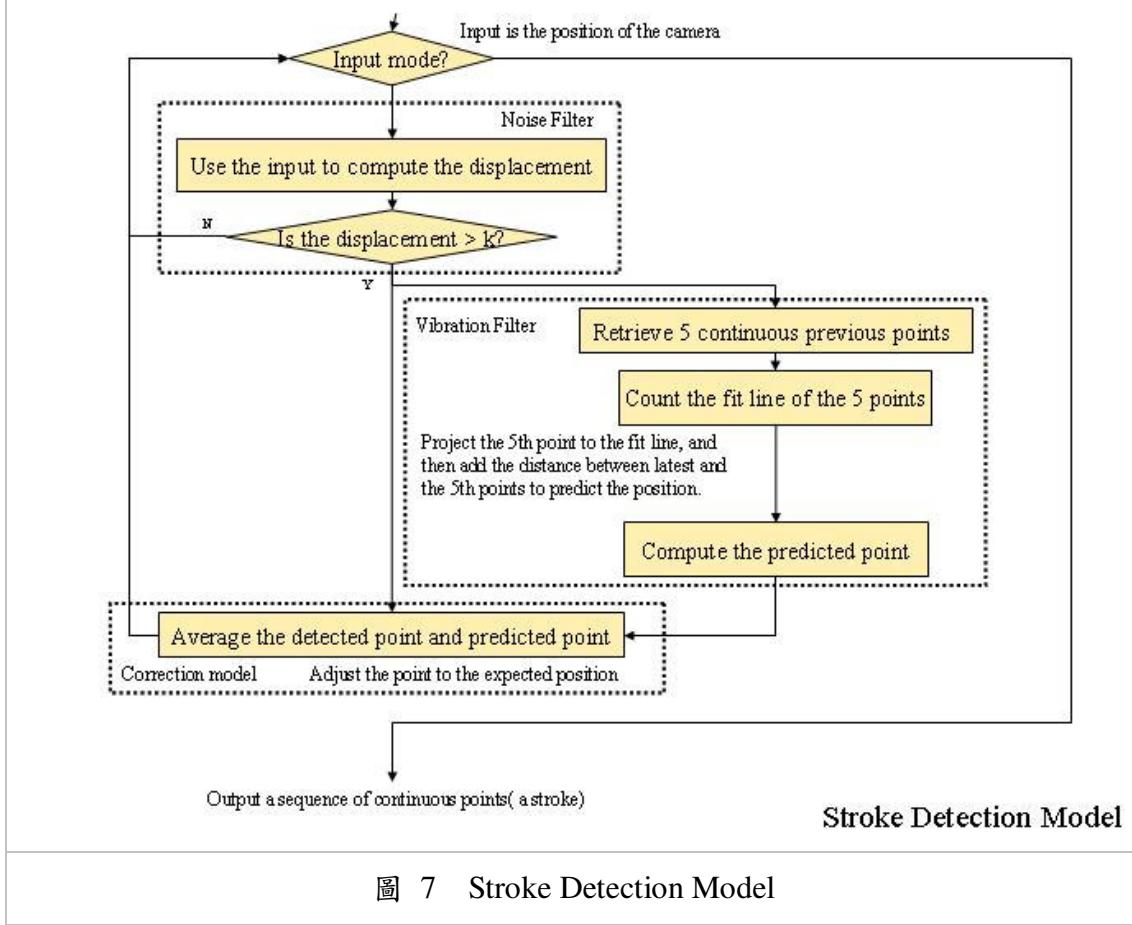
圖 7 Stroke Detection Model
