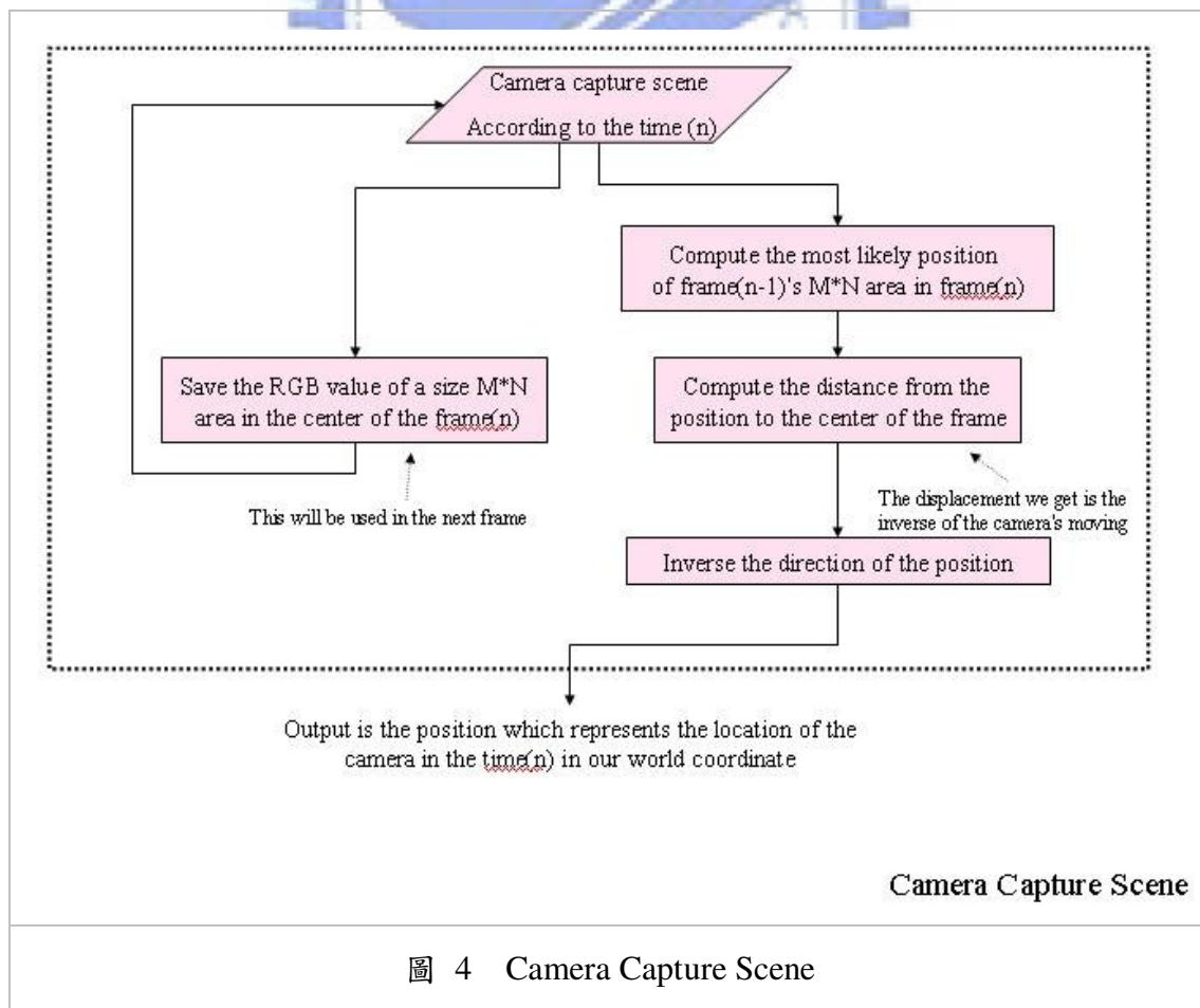
首先我們假設攝影機每一個 frame 的大小都是  $X * Y$  的 size，我們以畫面中心取出  $M * N$  大小的一塊區域作為特徵區域( $M < X$ ,  $N < Y$ )，藉由計算出本來在 frame T 中心的  $M * N$  區塊，在下一個 frame T+1 中的位置，我們就可以大略估算出 Camera 在這個時間內於空中的平面位移。
