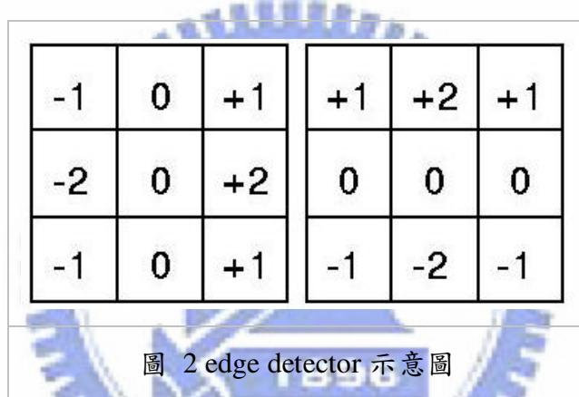
以影像處理所常用的各種 edge detector，先將影像做抓取 edge 的處理。之後再針對已經處理後的影像，選取具有特殊特徵的 edge 區塊做為系統的特徵區域，之後再對連續的影像之間搜尋特徵區塊的變動位置，以得到攝影機的移動資訊。
