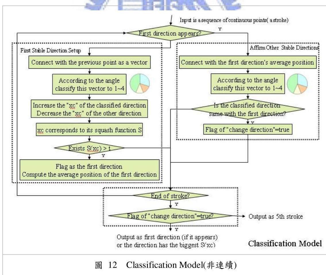
非連續輸入的流程分成兩個部份。第一個部份系統要先找出軌跡的方向，這部份我們使用 squash function 的概念，首先給 1~4 四種 vector 一樣的起始值，而隨著 evidence（這邊的 evidence 所指的是 sequential 的軌跡分成一段段的向量依序輸入）的輸入，依據 evidence 本身的方向，使同方向的 vector 的值上升，不同方向的值下降。而隨著四個 vector 本身的數值改變，對應到 squash function 的值會有指數的變化，而這個數值代表的是這個軌跡被分類成哪種方向的可能性最高。以下圖解釋 squash function 的對應情形：
