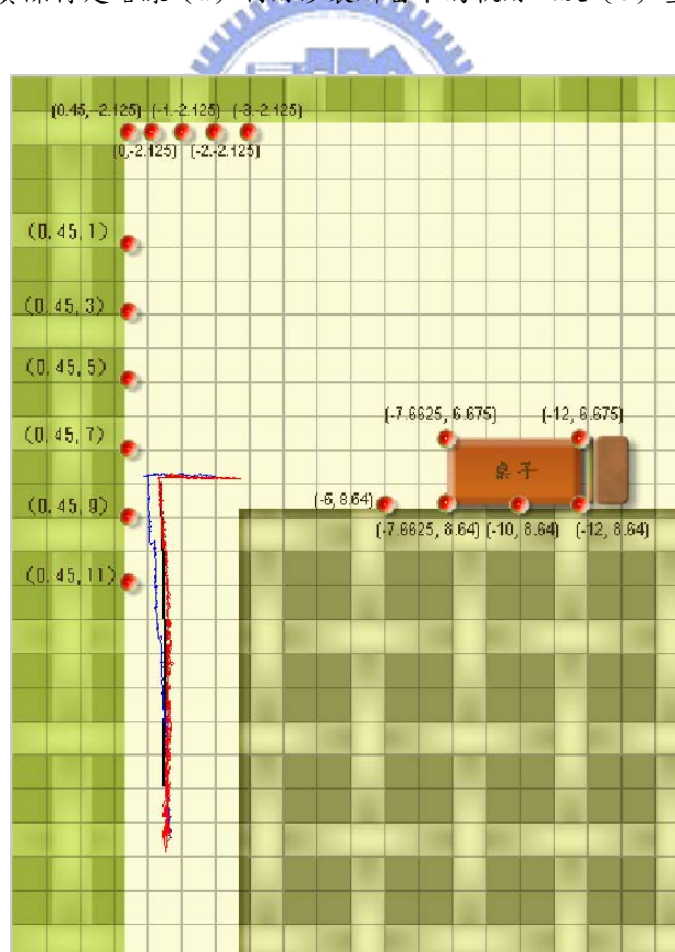
圖 5-12 基於工作空間座標系方法路線與實際行走路線 (紅色為以工作空間座標系為中心之平面轉換定位方法所得，藍色為以自動車座標係為中心之平面轉換定位方法所得，黑色為自動車真實路徑重建結果)
