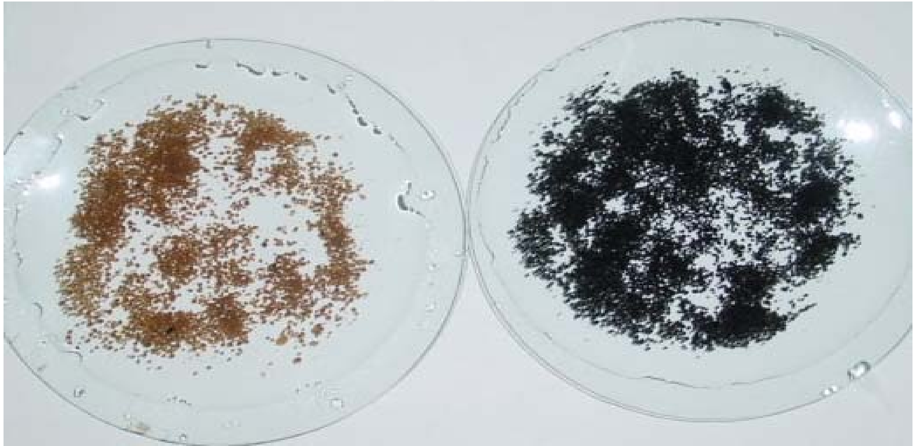
圖 4-6 曝氣槽中之顆粒化污泥 (a) 原始厭氧顆粒化污泥 (b) 曝氣 38 天後之顆粒化污泥
