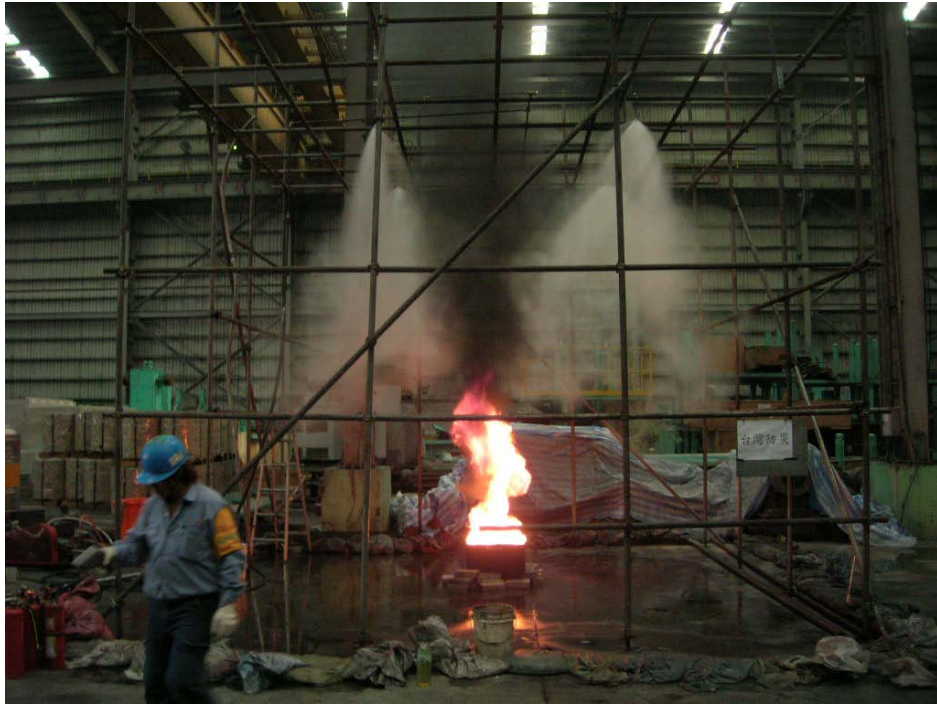
圖 4.2.1 室內大空間 60*60CM 二度空間油盤火實驗
