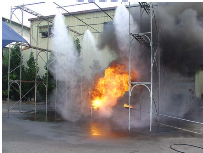
圖 3.2.17 室外三度空間細水霧噴頭 2x2 間距 3 米放射實景
