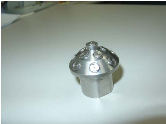
圖 4.2.5 自然通風實驗用噴頭 K=12.8 , 工作壓力為 100 \text{ Kg/cm}^2
