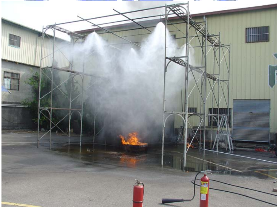
圖 4.2.2 室外空間 60*60CM 二度空間油盤火實驗
