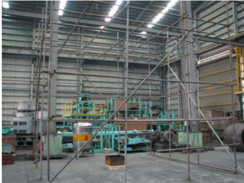
圖 3.2.3 室內空間實驗場地 5m x 5m x 5m 管架
