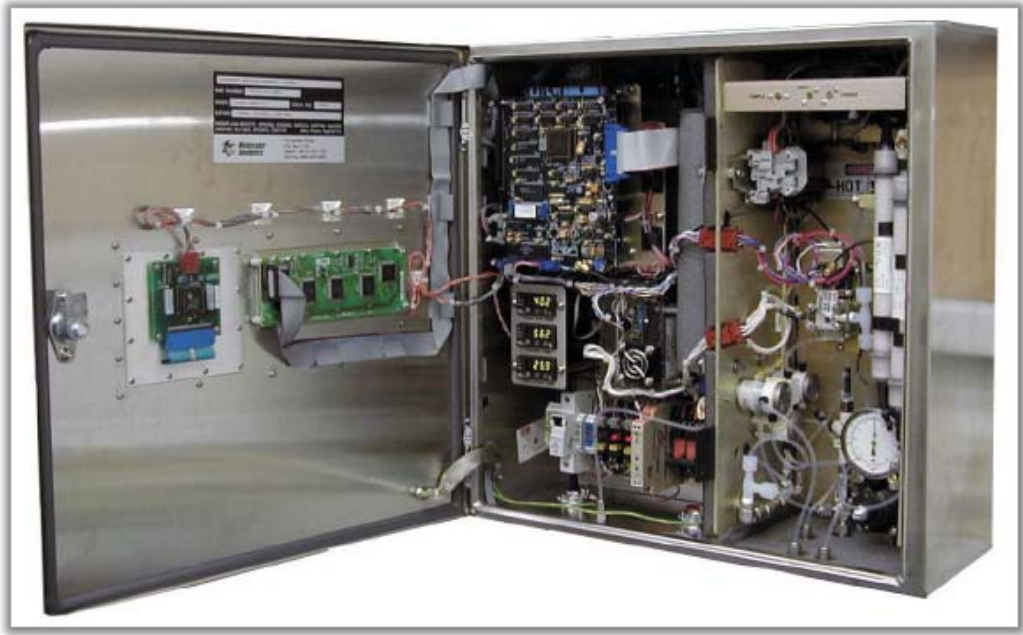
圖 3.4 IMS 分析儀內部構造
