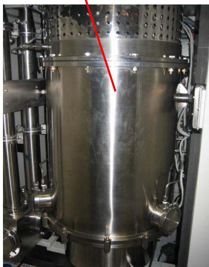
圖2-15電熱水洗式- ECS2250 電熱腔室及洗滌塔外觀圖
