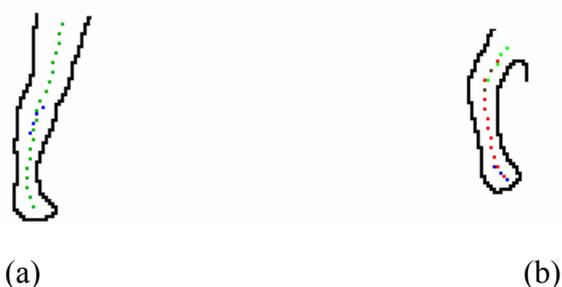
圖 14.產生交集的近似中心軸小段：(a)  $0^\circ$  掃描所獲得的近似中心軸小段(綠色)與  $45^\circ$  掃描所獲得的近似中心軸小段(藍色)有交集，(b)  $0^\circ$  掃描所獲得的近似中心軸小段(紅色)與  $45^\circ$  掃描所獲得的近似中心軸小段(藍色)和  $135^\circ$  掃描所獲得的近似中心軸小段(綠色)有交集。
