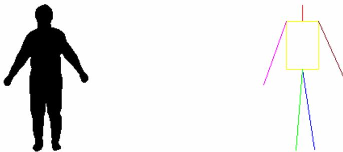
圖 28.以簡易線條和矩形建立人形圖樣：左側為人體影像、右側為人形圖樣。
