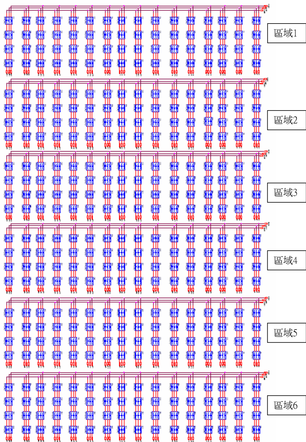
圖 4.9 15吋LED 驅動線路排列方式
