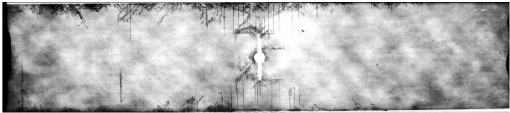
圖 3.40 [0_2/\pm 45_2/90_2]_s 破壞應力 95%的破壞區X光顯像圖
