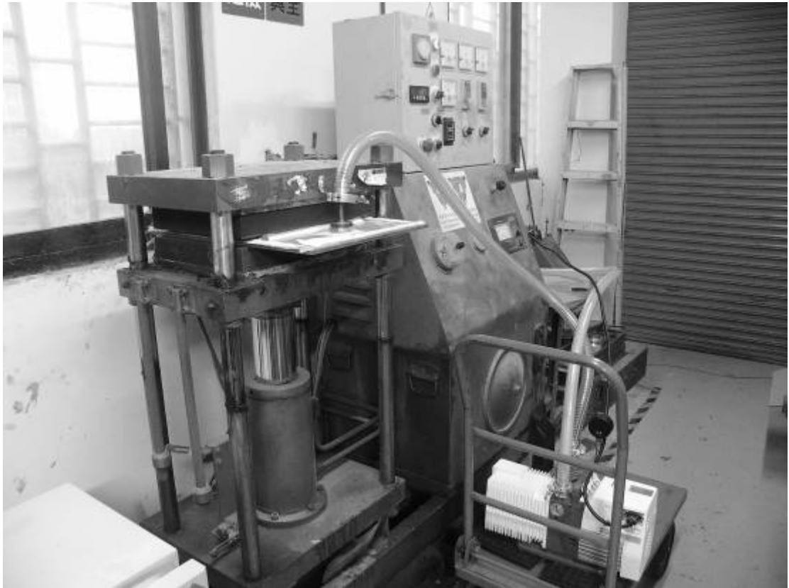
圖 2.1 熱壓機設備圖
