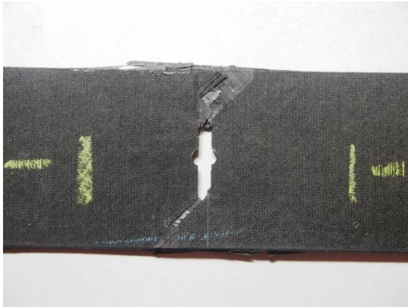
圖 3.33 [90/\pm 45/0]_{2s} 層板有裂紋試片破壞形式
