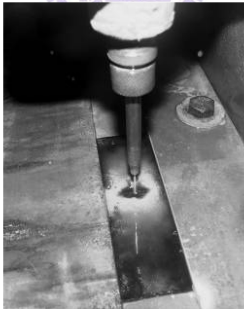
圖 2.7 水刀水柱切削複合材料板圖 ( 拍自台北祥焜工業公司 )
