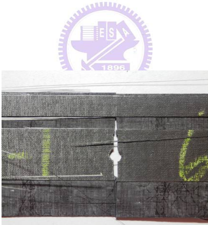
圖 3.27 [0/90]_{2s} 層板有裂紋試片破壞形式
