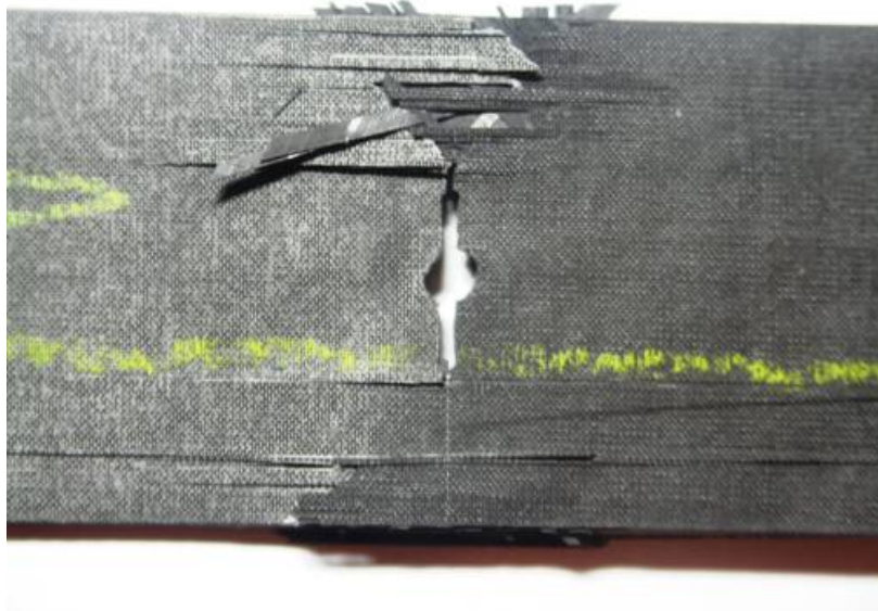
圖 3.31 [0/\pm 45/90]_{2s} 層板有裂紋試片破壞形式
