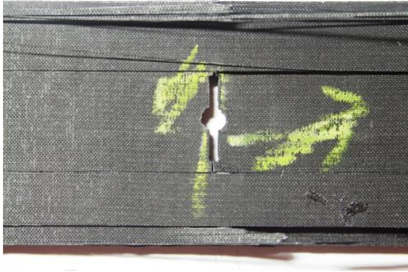
圖 3.27 [0/90]_{2s} 層板有裂紋試片破壞形式
