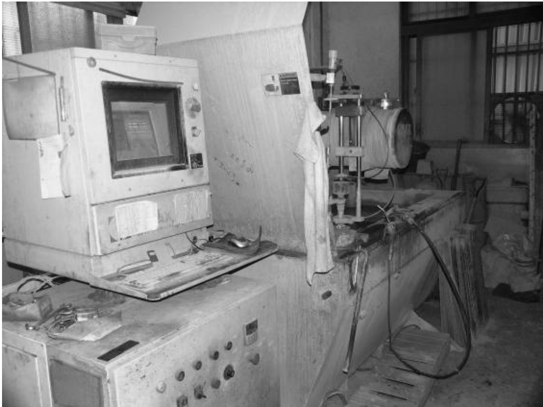
圖 2.6 美國 OMAX-2652 水刀加工機 ( 拍自台北祥焜工業公司 )
