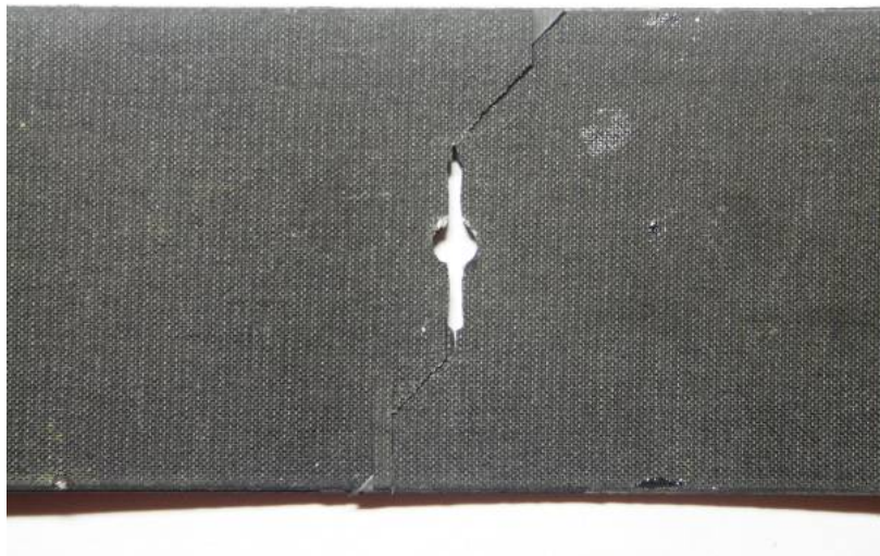
圖 3.34 [90_2/\pm 45_2/0_2]_s 層板無有裂紋試片破壞形
