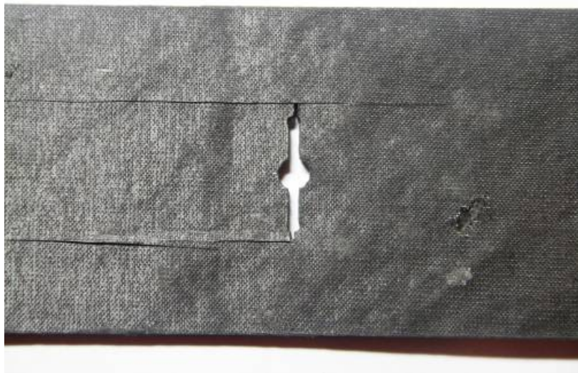
圖 3.32 [0_2/\pm 45_2/90_2]_s 層板有裂紋試片破壞形式
