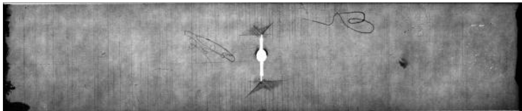
圖 3.42 [90_2/\pm 45_2/0_2]_s 破壞應力 95%的破壞區X光顯像圖
