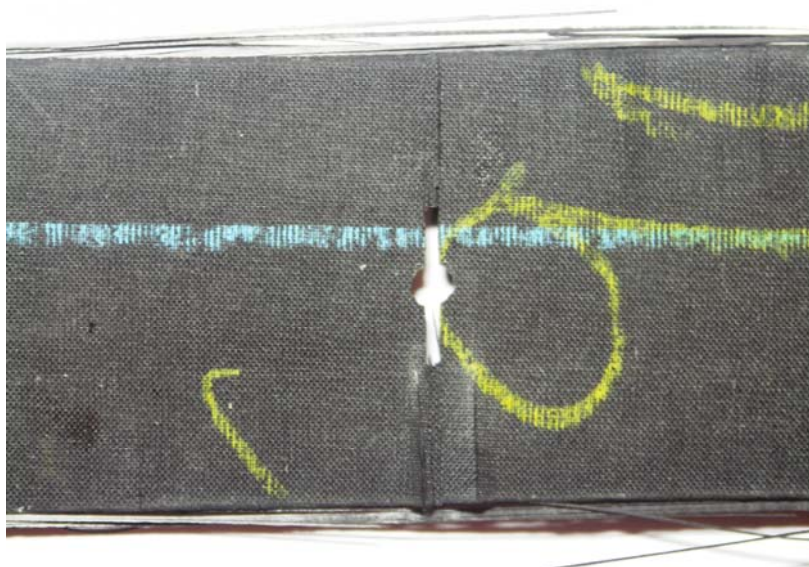
圖 3.30 [90_2/0_2]_s 層板有裂紋試片破壞形式
