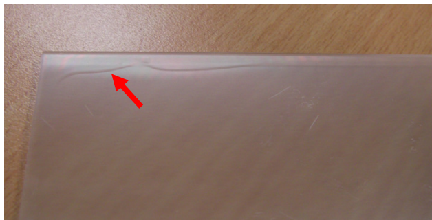
圖 4-11 導光板邊緣流痕示意圖
