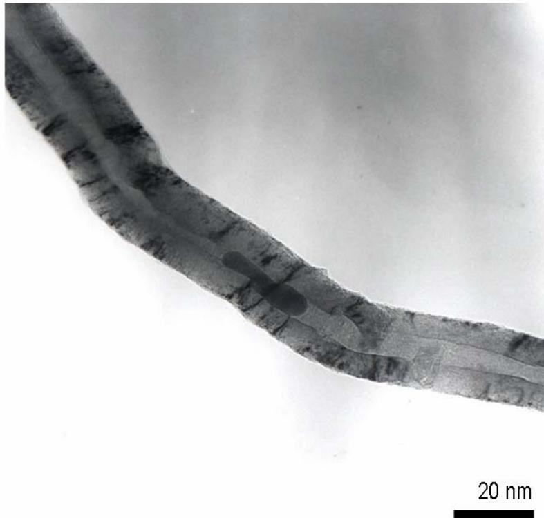
圖 4.11  $\text{CF}_4/\text{O}_2$  電漿處理後表面蝕刻形貌-5min-20nm
