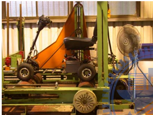
圖 27 電動代步車架設在耐久測試機上
