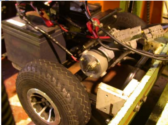
圖 30 電動代步車的動力組件
