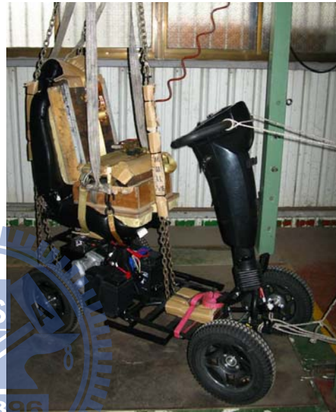
圖 69 電動代步車的墜落測試
