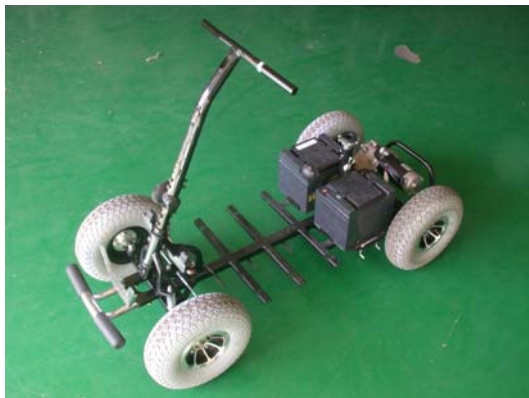
圖 70 電動代步車車架結構
