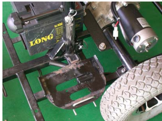
圖 71 電動代步車車架龍骨與座管處結構
