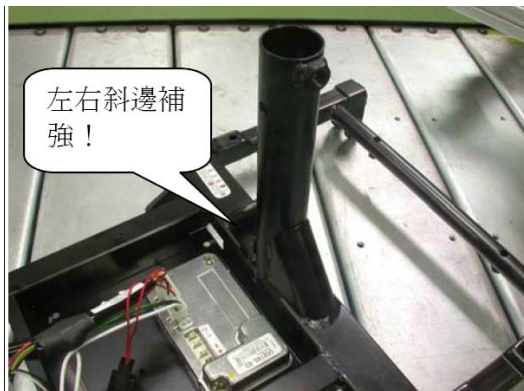
圖 76 圓形座管左、右斜邊補強
