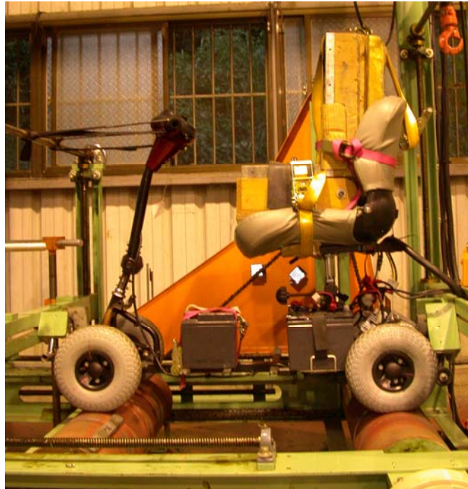
圖 5 耐久測試(Two Drum Test)機台實際測試的情況
