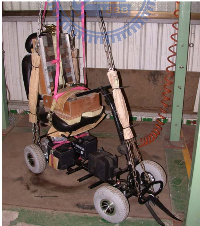
圖 7 墜落測試(Drop Test)機台實際測試的情況
