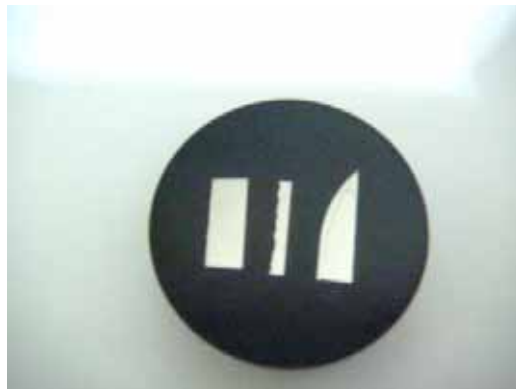
圖 3-6 金相觀察及微硬度試片
