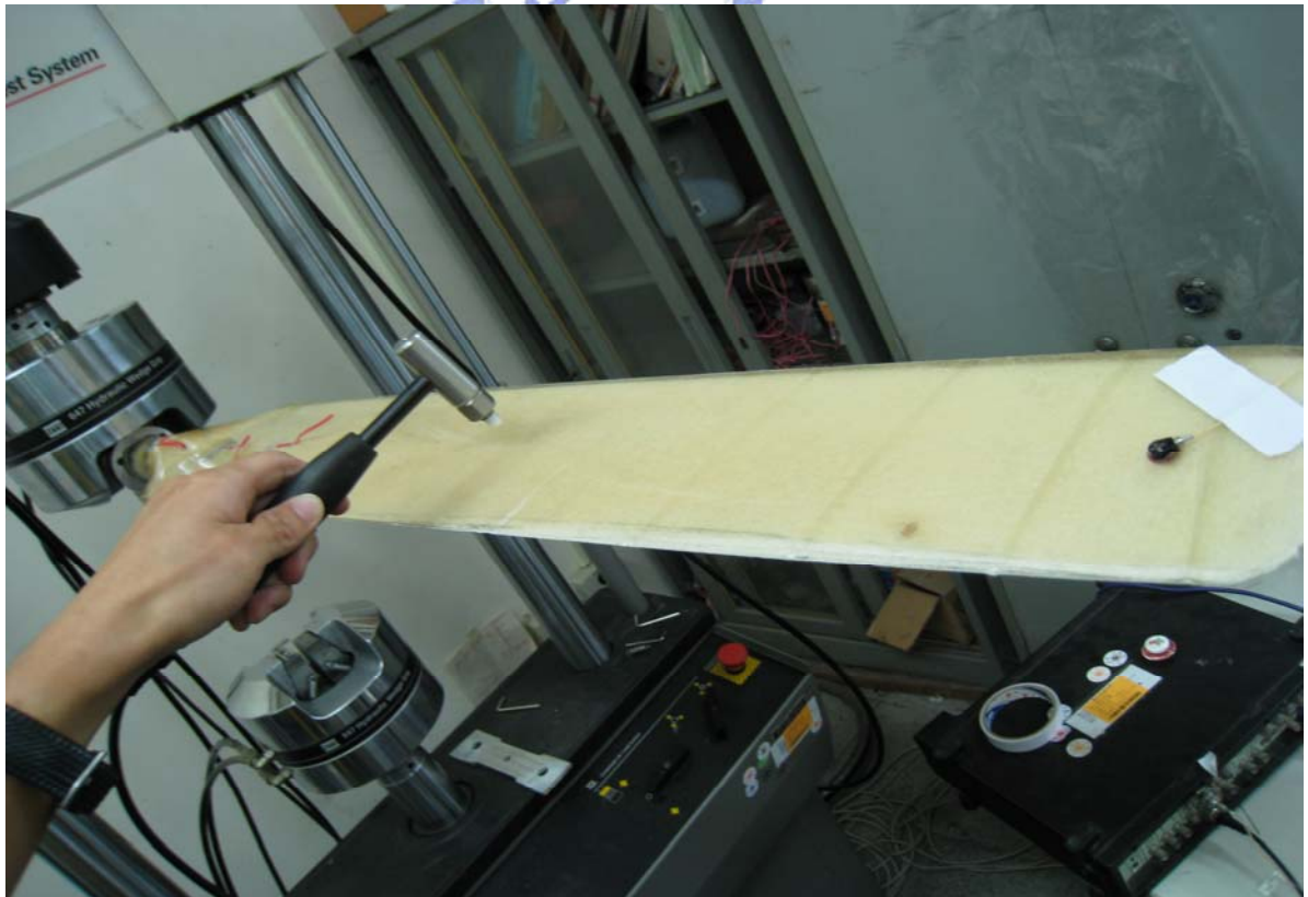
圖 43 阻尼量測實驗示意圖
