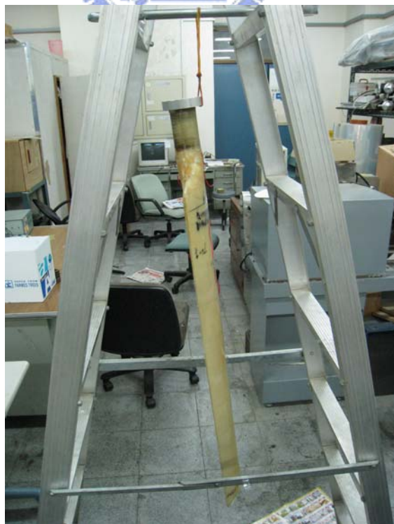
圖 41 自然頻率量測試驗台架
