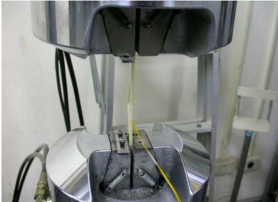
圖 3-2 拉伸試驗儀器架設概觀
