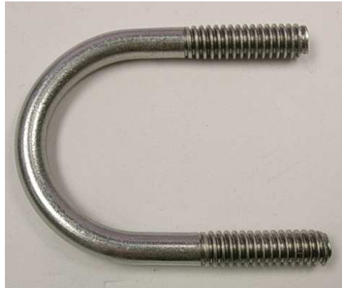
圖 5 滾軋加工螺紋再經彎曲成形製造之 U 型不銹鋼螺絲，注意素材桿徑為 \phi 5.2\text{mm} ，滾軋後螺紋大徑為 \phi 5.9\text{mm}
