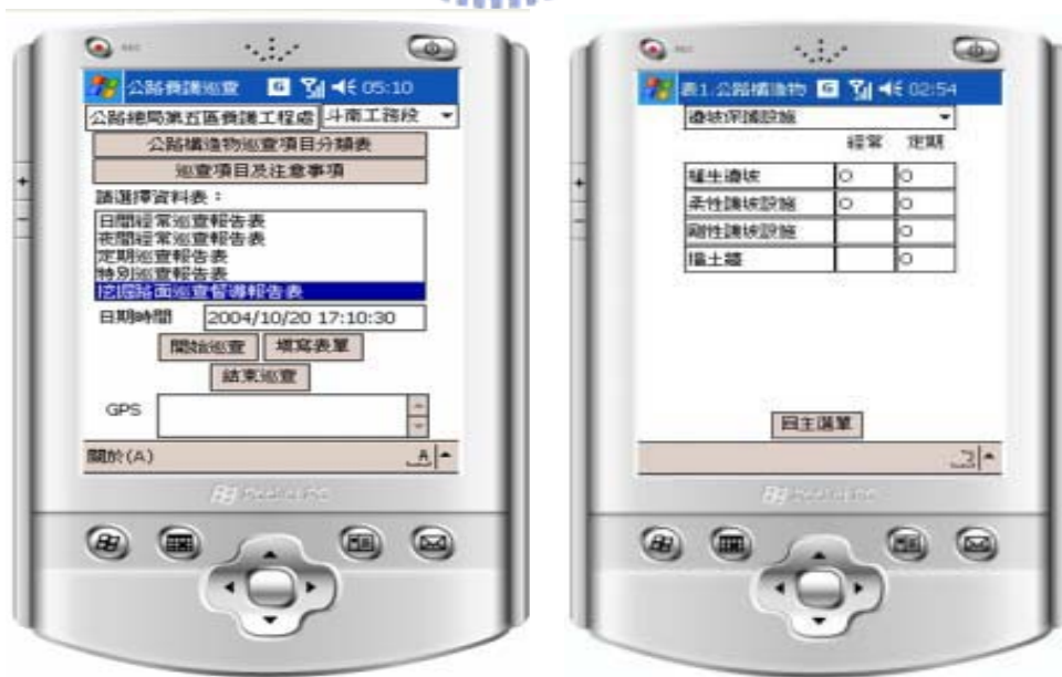
圖 4-1 運用 PDA 連結 GPS 定位，明確知道路面損壞位置
