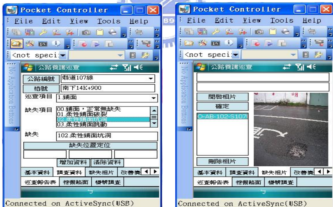
圖 4-6 利用養護巡查軟體(PDA 版)進行巡查並透過上傳軟體與電腦連線進行巡查紀錄控管流程
