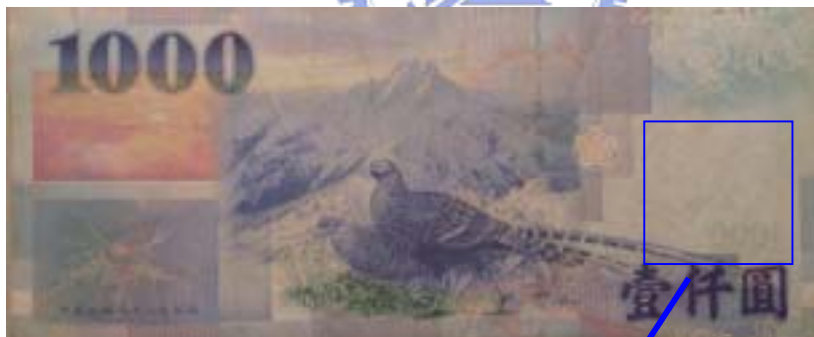
圖 3-4.a 以 THz Imaging 掃新台幣 100 元之浮水印
