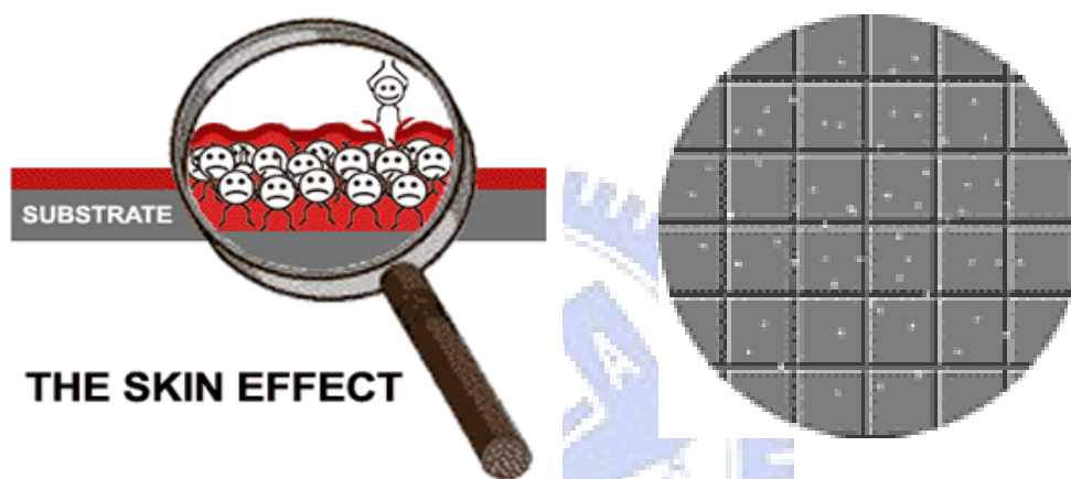
圖 2-7 厚膜光阻或烘烤溫度太高使光阻表面過早乾燥
