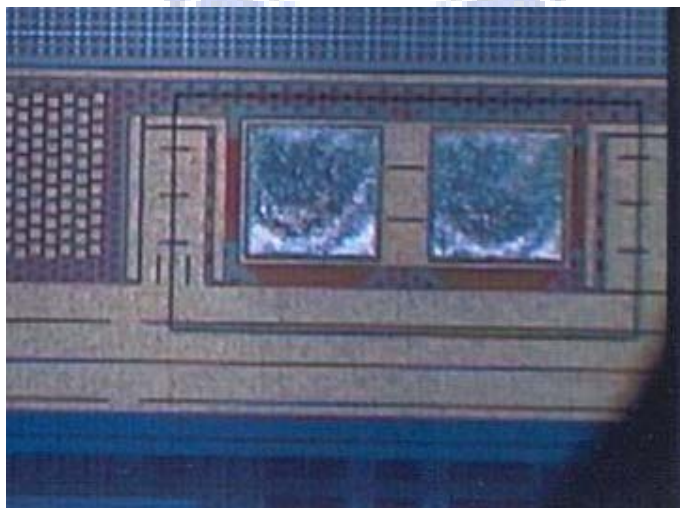
圖 3-16 金屬 Pad damaged
