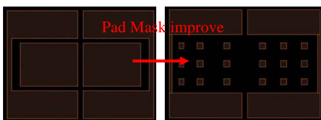
圖六 利用 Nitride pad mask 來避免 Aluminum 長時間暴露於 SF6 下
