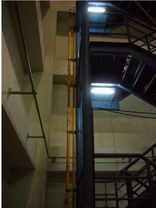
圖 4.11 交通大學結構大樓 9M 傾斜觀測管測試場景
