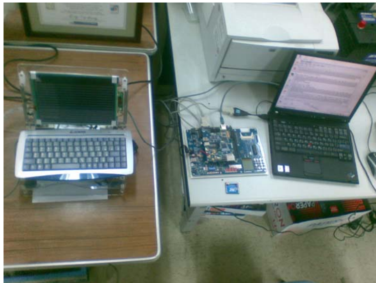
圖 6-9 R6-02 Ad hoc 模組與 MAC 模組介面測試實體照片 由左而右依次為 Ad hoc 模組、MAC 模組、MAC 模組之終端顯示器
