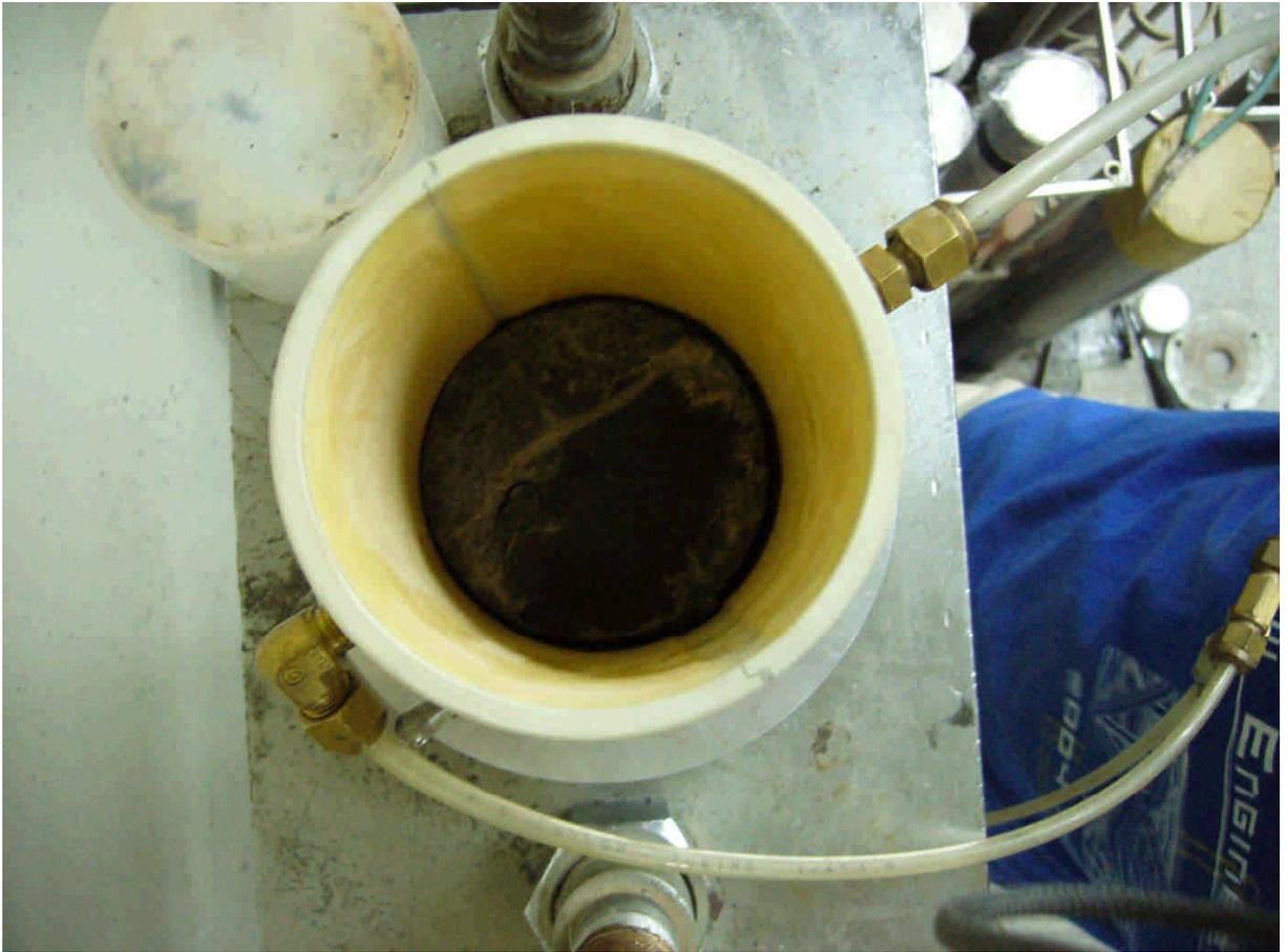
圖 3.17 試體進入 sampler holder
