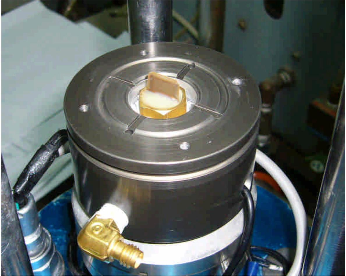
圖 3.8 激發端剪力波元件設備
