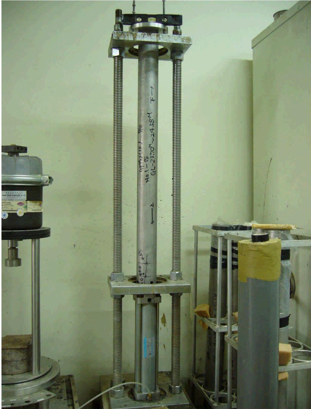
圖 3.13 將薄管置於氣壓式頂土器上
