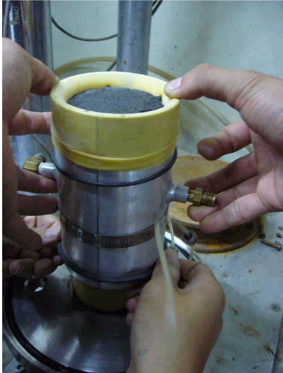
圖 3.18 使用 sample holder 保護試體
