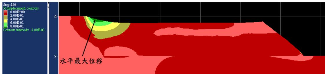
圖 4-55 掩埋面長度(L)為 50 m 之水平方向位移分佈圖
