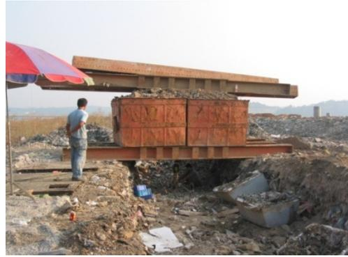
(b)架設反力系統
