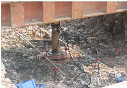
圖 7 直接剪力試驗現場佈設示意圖
