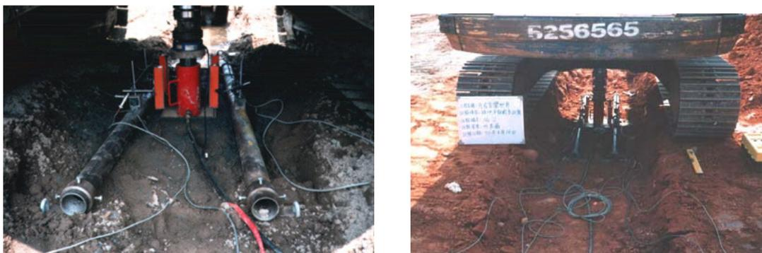
圖 3-4 平板載重試驗現場施做狀況
