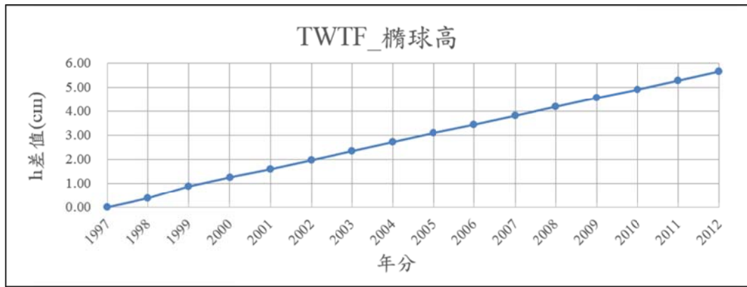
圖 3-5b、TWTF 衛星追蹤站點位高程坐標 1997 至 2012 年變化
