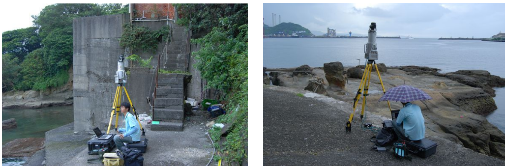
圖五：光達掃描(左 K1、右 K2)作業
