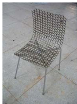
圖二十六、焊接加工後變形的金屬環椅面
