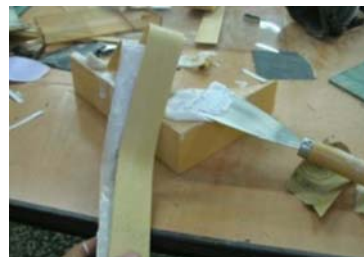
圖十五、以白膠黏合彎曲竹片
