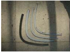
圖二十九、依邊緣區線切割支鐵片
