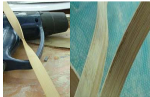
圖十四、扭轉測試圖與彎曲測試圖
