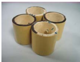
圖二十三、運用鉚釘連結竹管之測試
