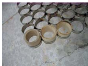
圖二十五、支撐用金屬環上套進竹管
