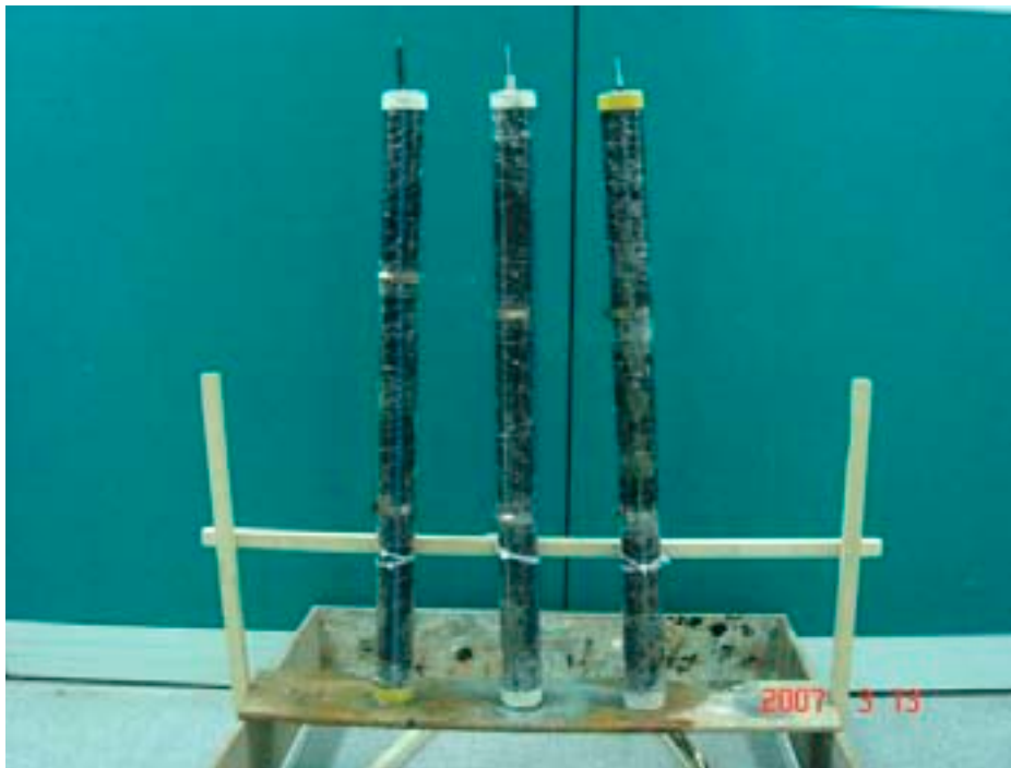
圖 4.59 水泥-纜線複合材料製作過程
