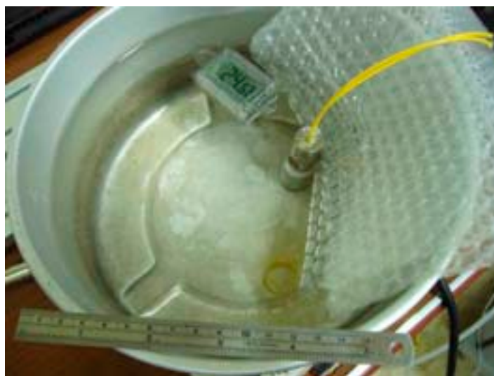
圖 4.27 等週期式 FBG 水壓計置於裝滿水之容器示意圖
