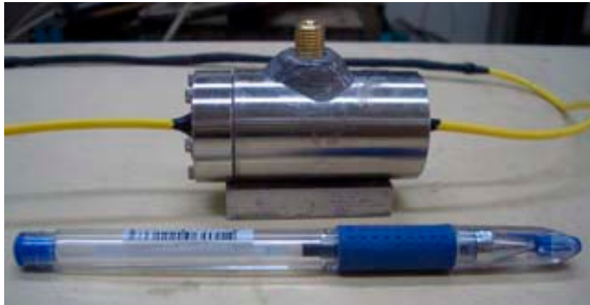
圖 4.19 等週期光纖光柵實體圖(量測範圍 10kg/cm 2 )
