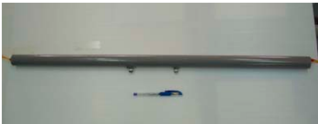
圖 4.25 PVC 管壓力封層測試實體
