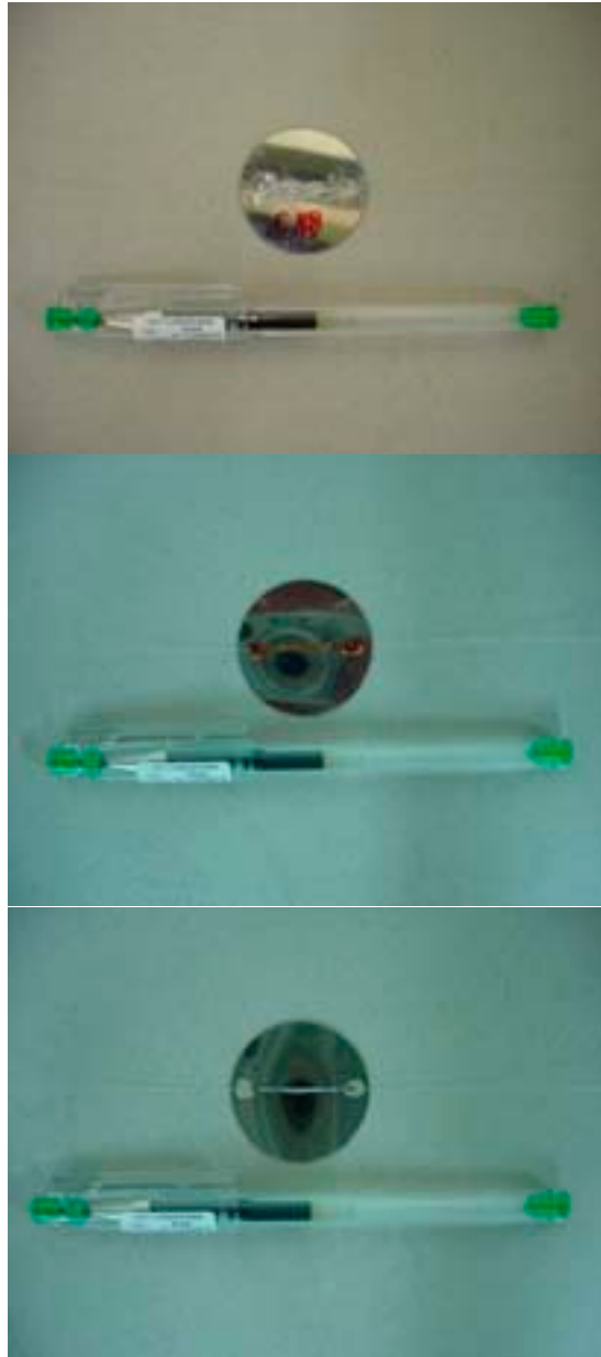
圖 4.10 三種黏貼膠於鋼模片之黏著力測試
