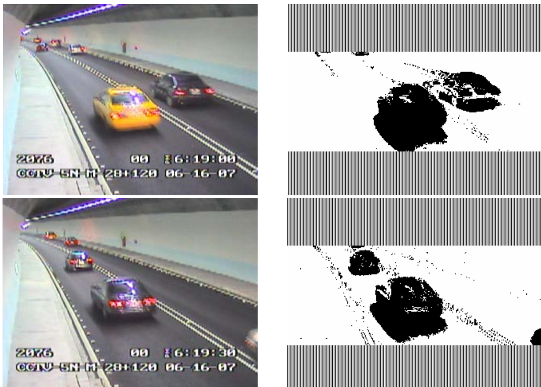
圖 5.4.2-1 雪山隧道編號第 2076 支 CCTV 攝影機物件切割成果
