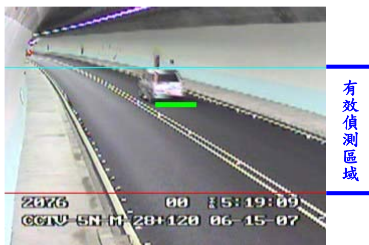
圖 5.4-1 CCTV 影像有效偵測區域示意
