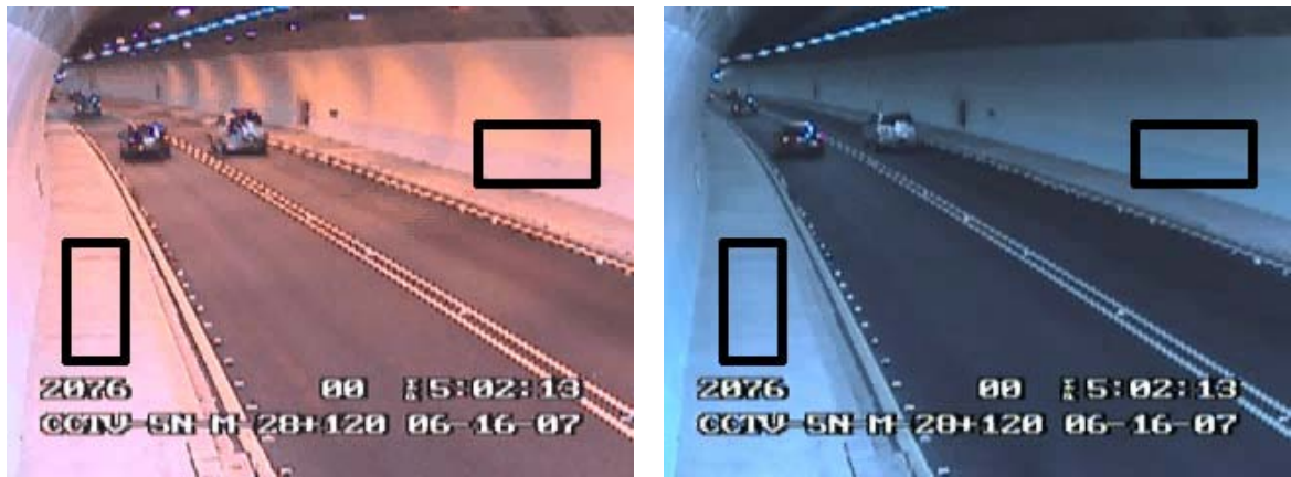
圖 3.1-4 燈光切換偵測區示意圖
