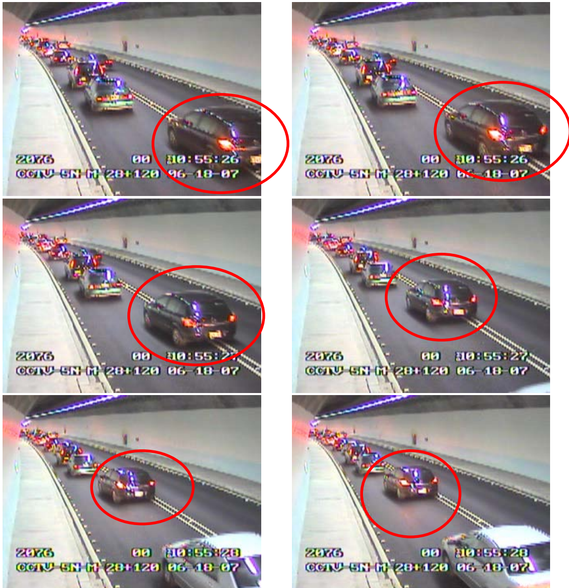
圖 5.3-2 隧道內變換車道
