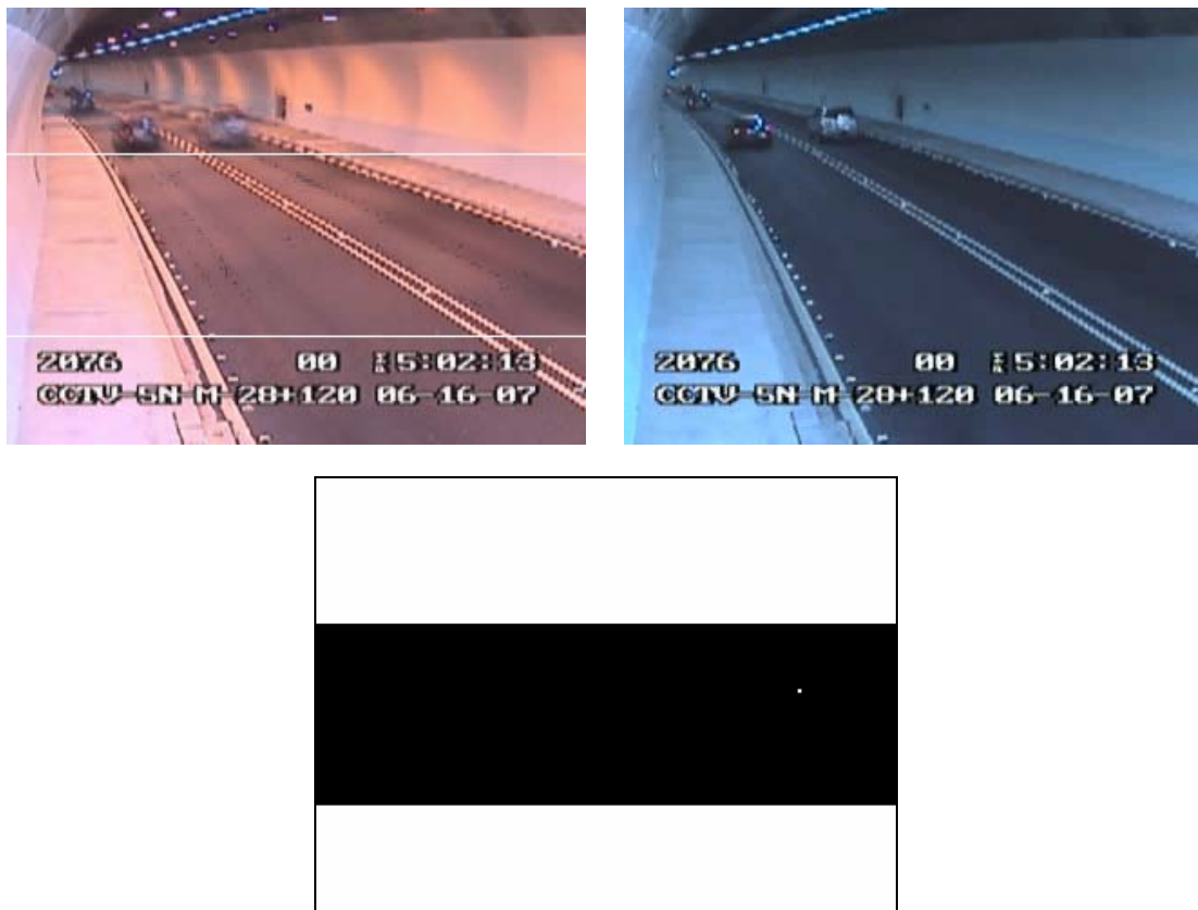
圖 3.1-2 燈光切換瞬間背景相減示意圖與結果
