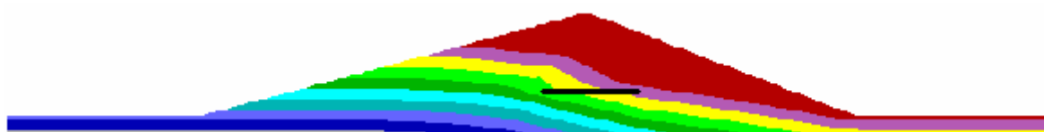
圖 5.18d 裂縫二長度比 1.0 時孔隙水壓分佈
