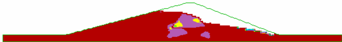
圖 5.20d 裂縫二長度比 1.00 時水力坡降分佈( i_{\max}=1.12 @ 壩心內)
