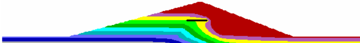
圖 5.17c 裂縫一長度比 0.71 時孔隙水壓分佈
