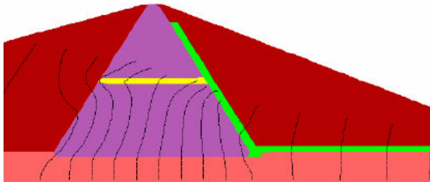
圖 5.23d 裂縫一長度比 1.00 時水頭分佈
