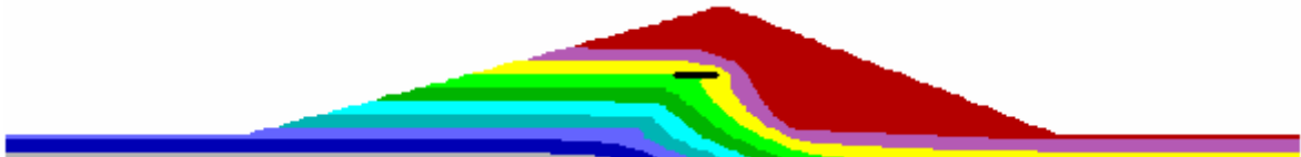
圖 5.17b 裂縫一長度比 0.43 時孔隙水壓分佈
