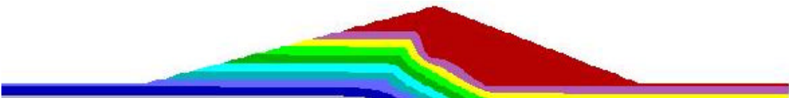
圖 5.26c 存在垂直裂縫面時之孔隙水壓分佈 (裂縫面 k/k_o=100 )
