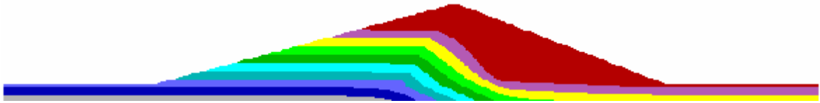
圖 5.17a 裂縫一長度比 0.00 時孔隙水壓分佈
