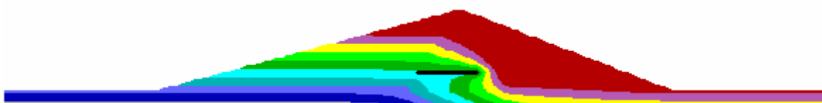
圖 5.18c 裂縫二長度比 0.7 時孔隙水壓分佈
