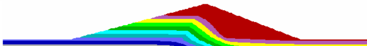
圖 5.18a 裂縫二長度比 0.00 時孔隙水壓分佈
