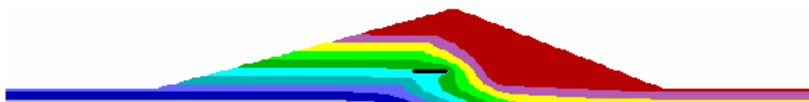
圖 5.18b 裂縫二長度比 0.4 時孔隙水壓分佈
