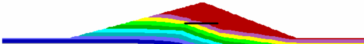
圖 5.17d 裂縫一長度比 1.00 時孔隙水壓分佈
