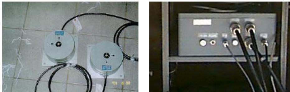
圖 5.65(b) 強震儀及資料擷取系統
