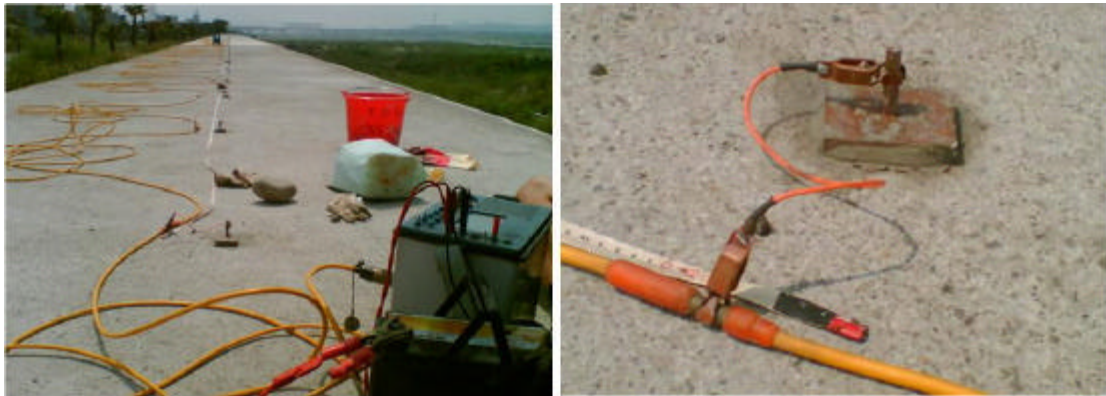
圖 4.16 非侵入式電極施測示意圖
