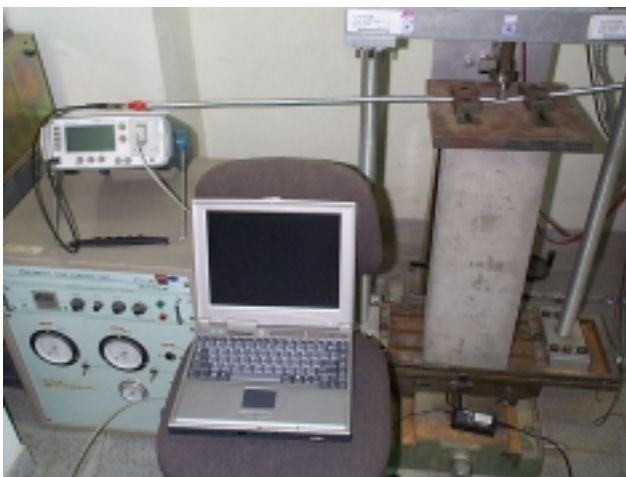
圖三 TDR 變形量測標定試驗。
