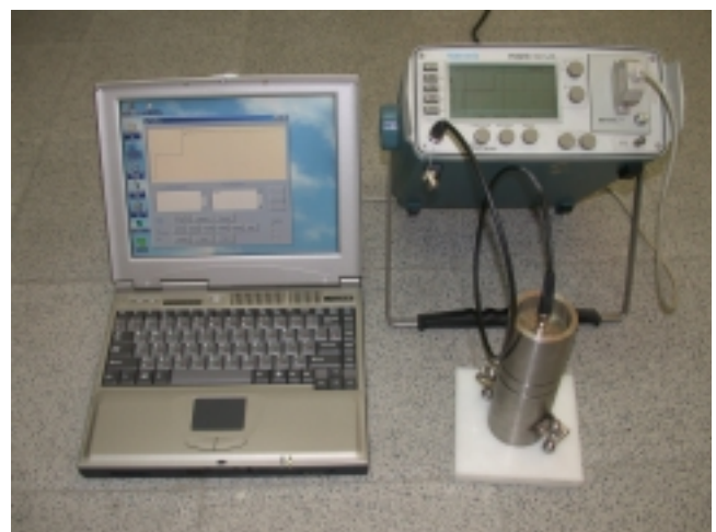
圖一 TDR 電學性質量測系統。
