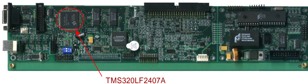
圖 8.4 研製完成的 PV inverter DSP 數位控制器
