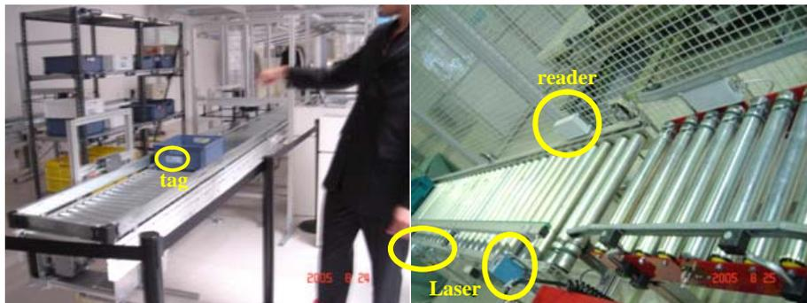
德國 OpenID 及 RFID Innovational Center 包裹自動分類取件系統所裝設之高頻 RFID
