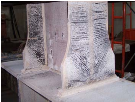
圖 12 試體 WF6-1 梁翼降伏
