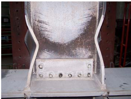
圖 13 試體 WF6-1 梁翼與梁腹局部挫屈
