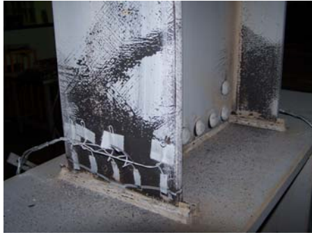
圖 11 試體 PN 上翼板沿寬度方向撕裂 (3% drift)
