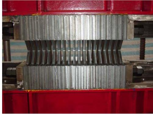
圖 4.5 (b) 原型 USD 制震鈹元件測試之試驗架構
