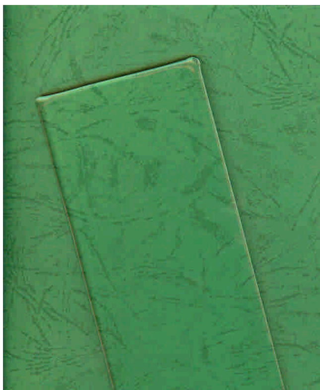
圖 12 火焰拋光後玻璃刮痕已被消除 (試片尺寸 22cmx7.5cmx0.5 cm)
