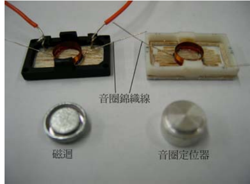
圖 7 揚聲器半成品與磁迴、音圈定位器
