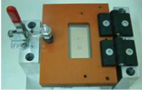
圖 6. PLED 瑕疵檢測取像機構設計
